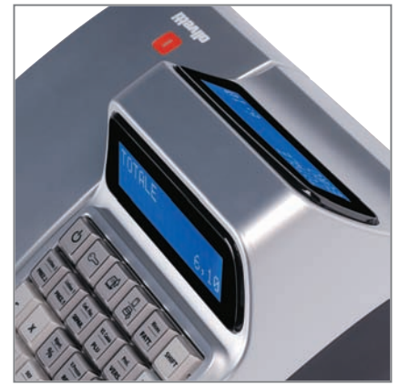
DISPLAY OPERATORE E CLIENTE retroilluminati
